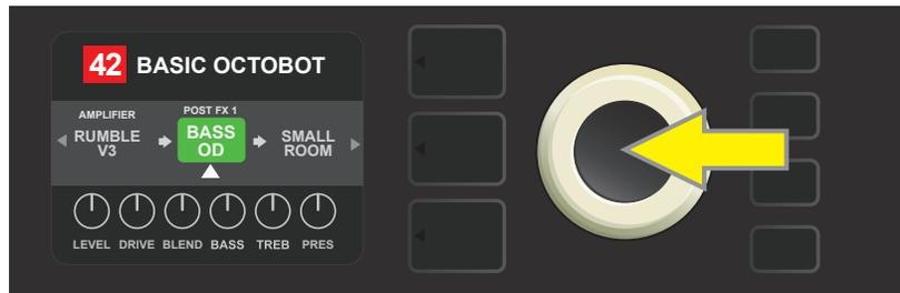
Après avoir déplacé l'effet nouvellement ajouté en tournant la molette, appuyez sur la molette pour sélectionner sa nouvelle position dans le niveau du chemin du signal.
