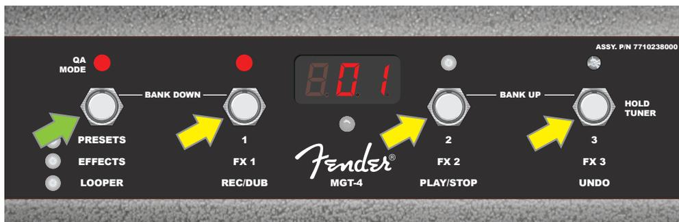
Appuyez sur le contacteur de mode du pédalier (flèche verte) pour parcourir les modes jusqu'à ce que la LED de mode rouge « QA MODE » s'allume (en haut à gauche). Les trois pré-réglages QUICK ACCESS sont affectés aux contacteurs de fonction 1, 2 et 3 (flèches jaunes), chacun avec sa propre LED de fonction rouge pour indiquer son utilisation. L'écran d'affichage affiche également le pré-réglage QUICK ACCESS (pré-réglage 1 dans cette illustration).
