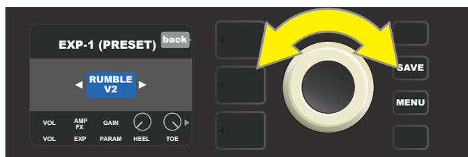
Dans PRESET SETTINGS utilisé pour la pédale EXP-1, l'amplificateur et les effets d'un préréglage auquel la pédale EXP-1 peut être affectée sont affichés un par un dans le SIGNAL PATH LAYER. La molette est utilisée pour les faire défiler à l'écran.
