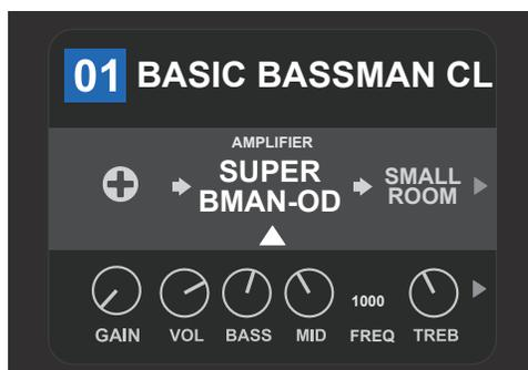
Le modèle de l'amplificateur préréglé à ce NIVEAU DU CHEMIN DE SIGNAL, désigné par la flèche blanche et le mot « Amplifier » est entouré à droite du champ indiquant l'effet et à gauche un champ vide.
