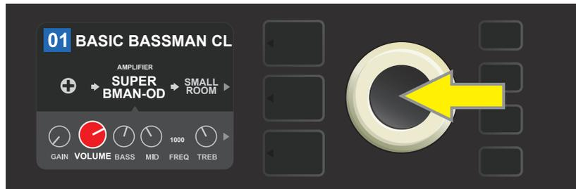
Appuyez sur la molette pour sélectionner le bouton de commande du modèle d'amplificateur à régler.
