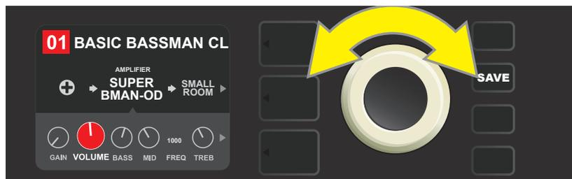
Tournez la molette à nouveau pour ajuster le réglage du bouton de commande du modèle d'amplificateur sélectionné.
