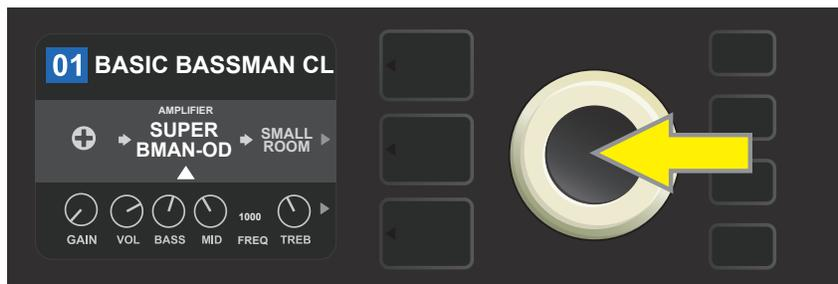
Pour remplacer le modèle d'amplificateur préréglé en surbrillance dans le niveau du chemin du signal (SIGNAL PATH LAYER) (comme indiqué ici par la flèche blanche en dessous et l'étiquette « amplifier » au-dessus) par un modèle d'amplificateur différent, appuyez d'abord sur la molette pour accéder au menu des autres modèles d'amplificateurs.
