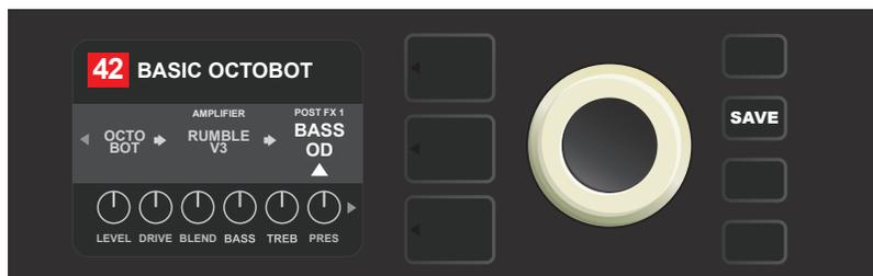
Avec l'effet remplacé (comme indiqué ici par la flèche blanche affichée en dessous et l'étiquette au-dessus), continuez à modifier d'autres paramètres ou appuyez sur la touche utilitaire SAVE allumée pour mémoriser les modifications réalisées.
