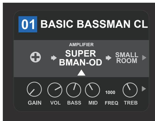
Affichage détaillé – un autre préréglage contenant un slot libre dans lequel l'effet peut être placé, ici désigné par un symbole représentatif (signe plus dans le cercle) tout à la fin du NIVEAU DE CHEMIN DE SIGNAL à gauche.
