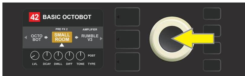
Après avoir déplacé l'effet sélectionné en tournant la molette, appuyez sur la molette pour sélectionner sa nouvelle position dans le niveau du chemin du signal.
