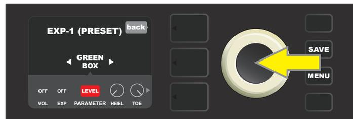
À partir de l'exemple ci-dessus, appuyez sur la molette (flèche jaune) sur la sélection « LEVEL ». Le champ passera du bleu au rouge, indiquant que le réglage de ce paramètre de l'effet d'overdrive Green Box pour l'utilisation de la pédale EXP-1 peut être fait.
