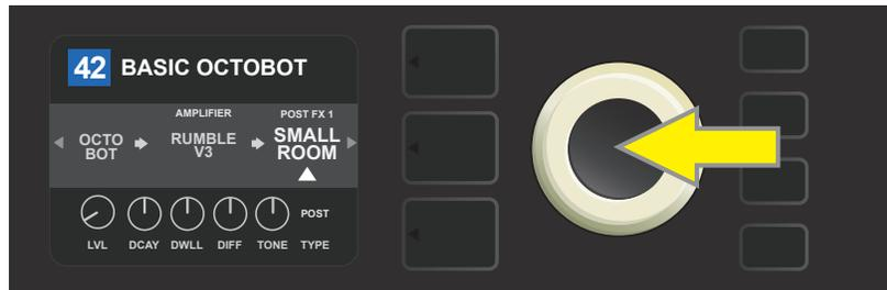
*Autre méthode d'ajout d'un effet : mettez en surbrillance un effet existant dans un pré-réglage en tournant la molette et en appuyant sur la molette pour voir le menu des quatre catégories d'effets.*
