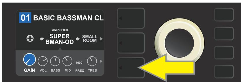
Appuyez sur la touche inférieure de niveau (LAYER BUTTONS) pour accéder au niveau des commandes pour le modèle d'amplificateur du préréglage sélectionné.
