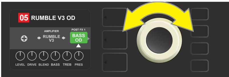
L'effet récemment ajouté, mis en surbrillance avec une flèche blanche en dessous et une étiquette au-dessus, apparaît dans une zone verte indiquant qu'il peut être laissé en place ou déplacé en tournant la molette dans une position différente au niveau du chemin du signal.
