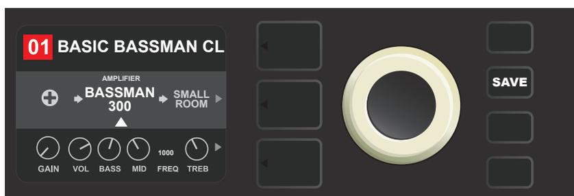
Une fois le nouveau modèle d'amplificateur en place, continuez à modifier les autres paramètres ou appuyez sur la touche utilitaire SAVE allumée pour sauvegarder les modifications réalisées.
